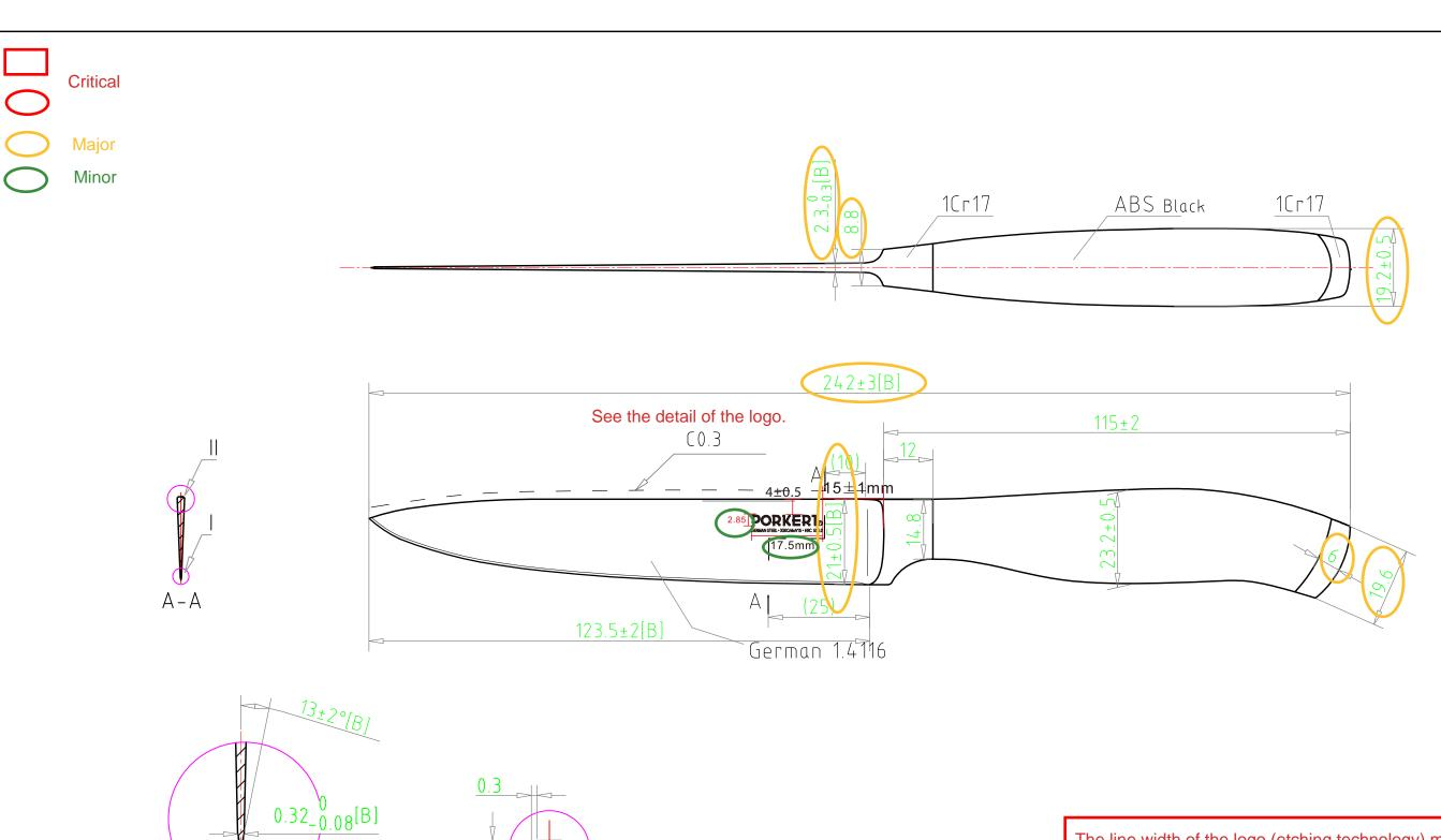
Tolerance unless otherwise specified 0-3mm ±0.5 >3-30mm ±1
